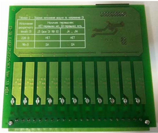
Рисунок 21 – Расположение и комбинации перемычек J4 . . . J14 для задания напряжений дискретных входов на 110 и 220 В
