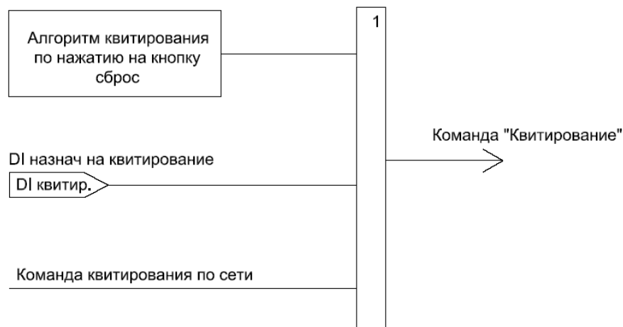
Рисунок 98 – Алгоритм работы функции квитирования
