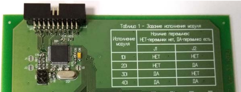
Рисунок 20 – Расположение и комбинации перемычек J1 и J2 для задания исполнений модуля DI
